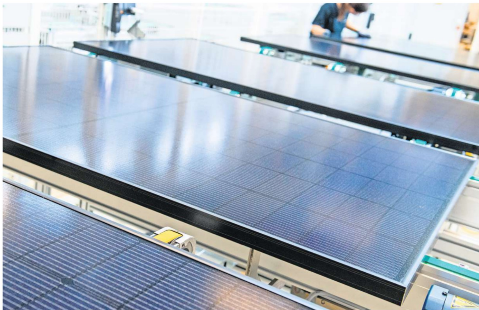
Endkontrolle einer Produktionslinie für Solarmodule der Firma Meyer Burger Technology in Freiberg (Sachsen).
